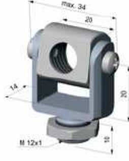
Montagegabel, justierbar in 2 Achsen, mit M12x1-Gewinde
