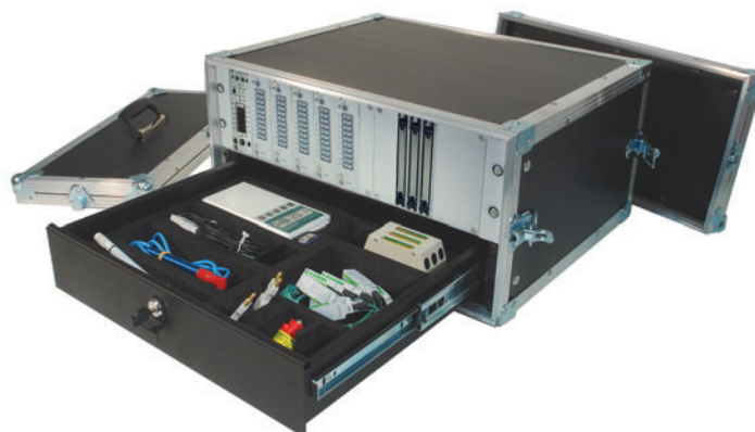
Rack Case mit Tragegriff, ZB5090RC für ALMEMO 5690-xxBT8 im Baugruppenträger 19"
