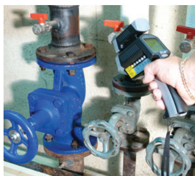
Temperaturmessung mit Fotoaufnahme
