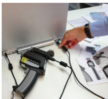
Daten vom AMiR 7814-30 auf einen Computer übertragen
