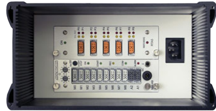
ALMEMO® 5790-2M09 IG2 Ansicht von unten, Boden geöffnet (Beispiel: Mastermeßkreis mit Relaiskarte ES5690RTA5)
