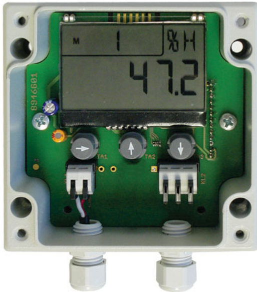
Transmitter mit geöffnetem Gehäuse
